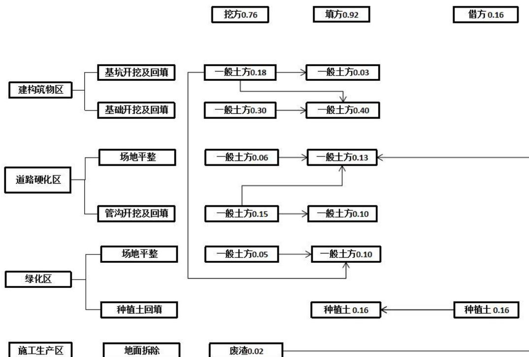
图 2-4 土石方平衡及流向框图（图中单位：万 m<sup>3</sup>）
